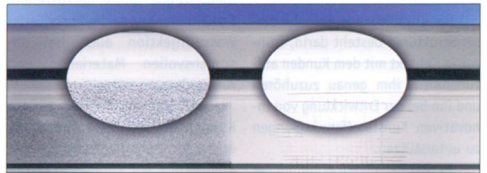
Lackierfähige Kunststoffe. Links: Standard Materialmischung mit schlechter Pulverdeckung; rechts: neue Technoform-Materialmischung erzielt im Gitterschnitttest geschlossene Pulverschicht mit sehr guter Haftung.
